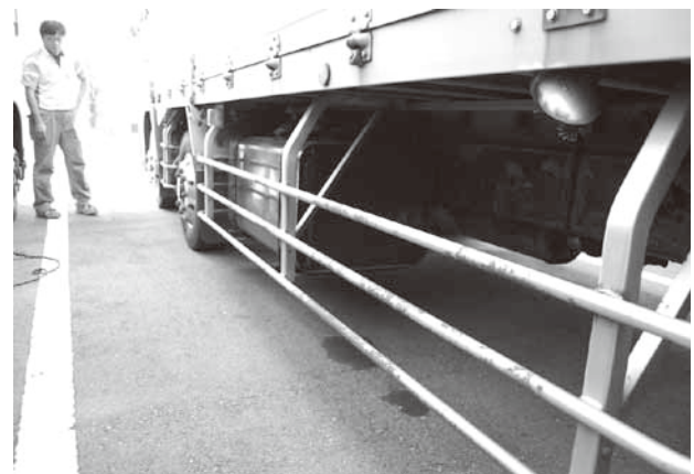
燃料タンクが取り外された車両 数百キロの軽量化効果があります。
