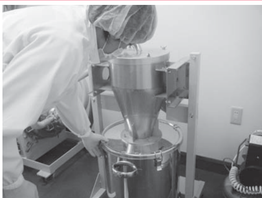
▶米粉をつくる気流式微粉碎機
