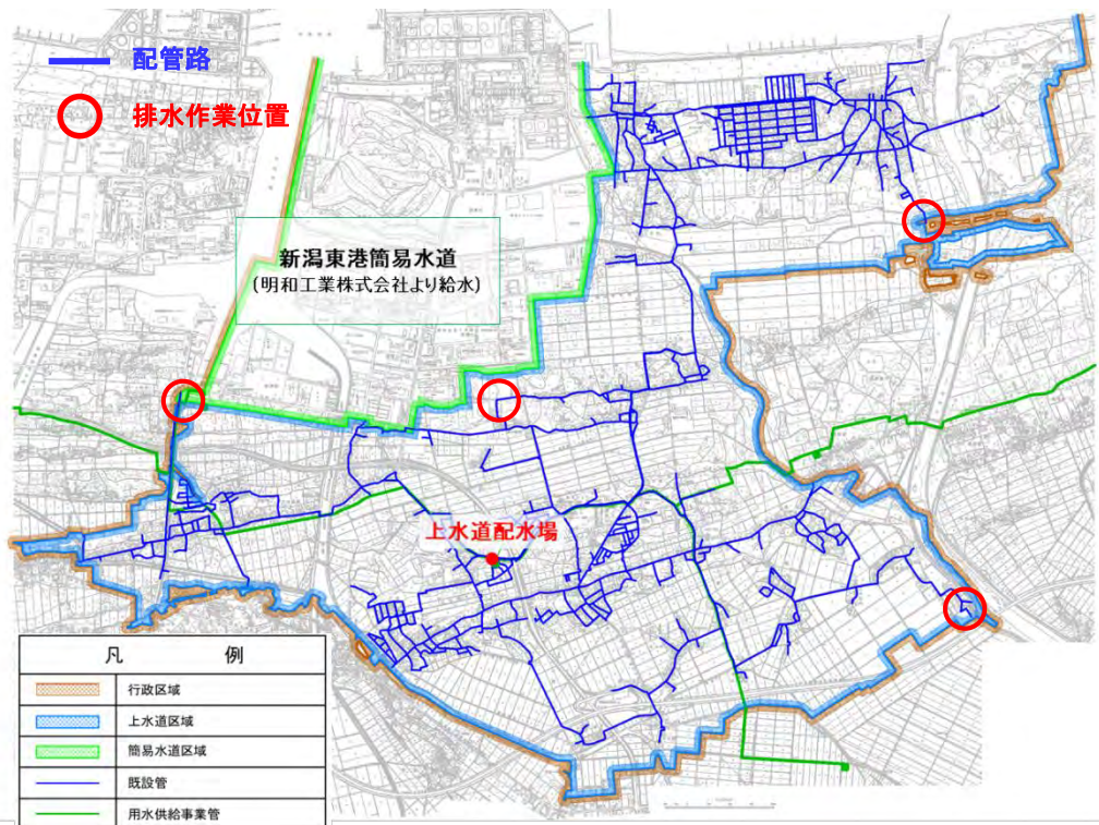
図 14 残留塩素確保のための排水作業位置
