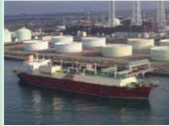
LNGを運ぶ船は、全長約300m、総トン数10万トンもある大型貨物船です。
